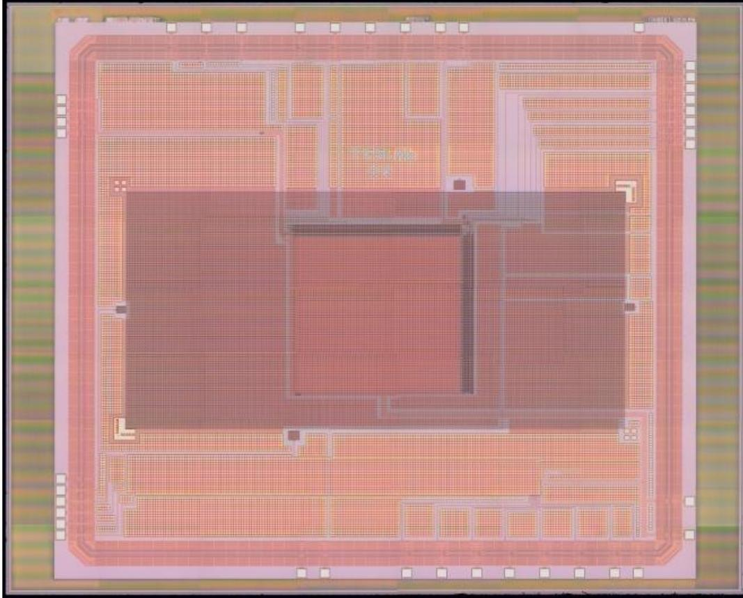
**Fig. 1.9** Optical Micrograph of ROIC die
